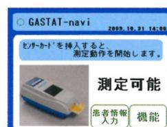
見やすいカラー液晶表示のタッチパネルを採用。視認性の向上で操作ミスの軽減をサポートします。
